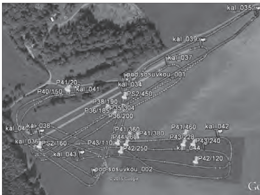
Obr. 2 Profily pod lomem Na Bradinách a detekované odrazy Fig. 2 Radar profiles beneath the Na Bradinách Quarry and detected reflections
