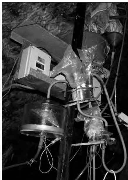
Foto 1 Přístrojové vybavení spojené s PC na jednom ze skapových míst v Ochozské jeskyni (Foto J. Himmel)
