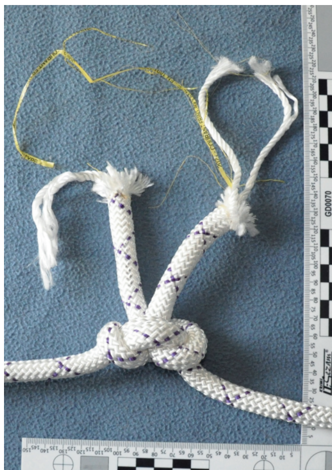
Obr. 6 Zkušební vzorek č. 10-2 po provedené zkoušce
